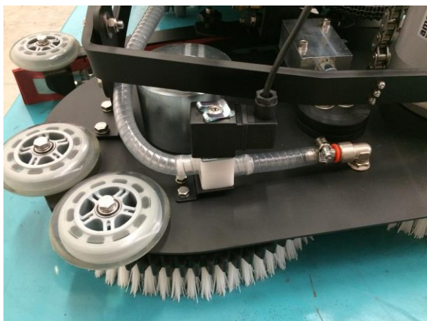
Magnetventil zum Regulieren des Wasserflusses Wasserdurchflusses
