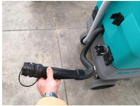
Ablassschlauch für schmutziges Wasser mit Durchflussregelung (flow control)
