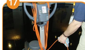
Das Kabel aufwickeln und dabei mit einem feuchten Tuch reinigen.
