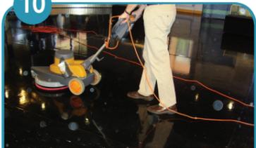
Nach jeder Bahn drehen Sie von der Steckdose weg. Das Kabel soll immer im gereinigten Bereich liegen. Bahnen 5cm überlappen.
