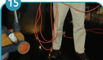
Bei Steckdosenwechsel, das Kabel von Maschine zu Stecker aufwickeln, nicht umgekehrt, um das Kabel nicht zu verwinden.
