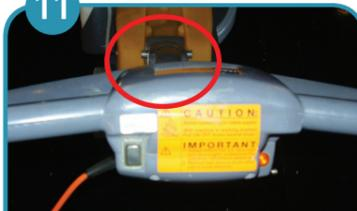
Betätigen Sie den Sprühmechanismus alle 5-10 Schritte. Stellen Sie sicher, dass das Pad nicht zu nass wird.
