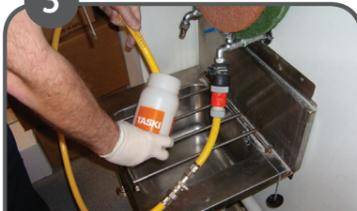
Wenn Spraypolieren, die Dosierflasche mit der benötigten Reinigungslösung füllen.
