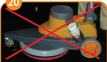
Pad und Padteller abmontieren, bevor die Maschine abgestellt wird. Pads gründlich reinigen und zum Trocknen hängen.
