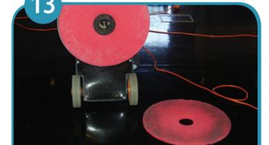
Wenn das Pad abgenutzt oder zu stark vermutzt ist, durch ein frisches Pad ersetzen.
