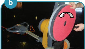
Maschine nach hinten kippen und den Pad-Teller montieren. Den Pad-Halter gegen der Uhrzeigersinn drehen.
