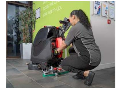
Leichter Zugang zu den Wechselakkus
